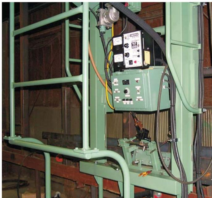
Панель управления снабжена органами управления перемещением и цифровой индикацией скорости, отображаемой как в дюймовой, так и в метрической системе.
