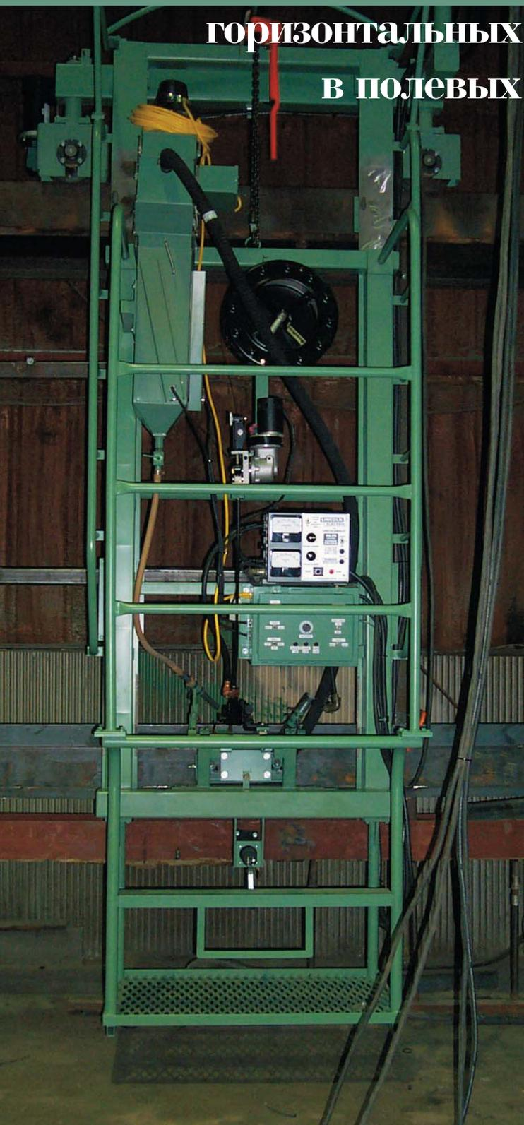
Система автоматической сварки резервуаров ATW (*Automatic Tank Welder*) компании Ogden представляет собой самоходный сварочный механизм для сварки под флюсом, разработанный специально для выполнения горизонтальных швов при изготовлении в полевых условиях нефтяных, газовых и зерновых резервуаров.
