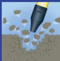
Энергия сжатого воздуха ведёт к взрывам этих полостей. Происходит измельчение почвы. Почва остаётся сухой, что облегчает её вакуумную выемку из раскопа и обратную засыпку.
