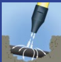
При достижении кабеля или трубы, воздушный поток, натываясь на их непористое покрытие, сжимается и рассеивается в окружающей почве, не нанося им ни малейшего вреда
