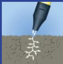
Сверхзвуковой воздушный поток, поступающий в почву под давлением 10-15 атм через сопло устройства, “загоняется” в эти микроскопические полости.
